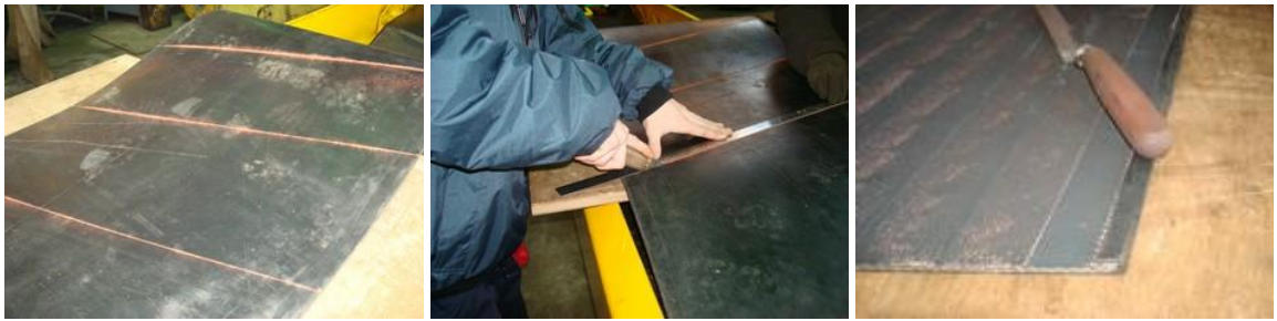
Разметка, расслоение конвейерной ленты. Формирование «ступеней» стыка.
