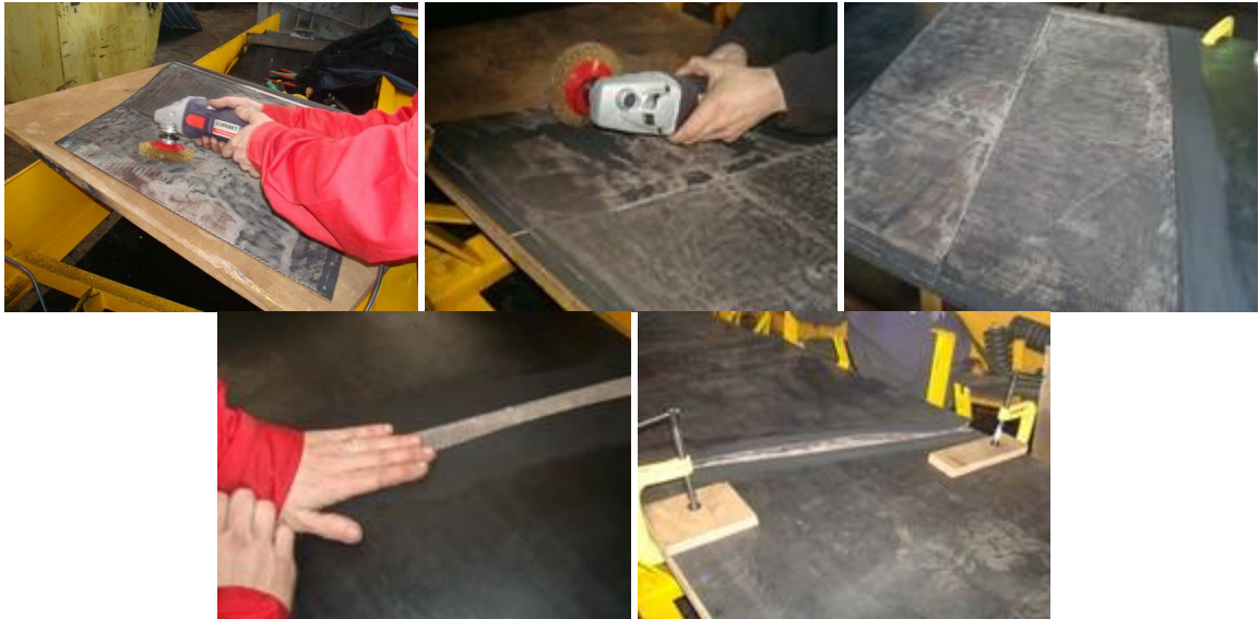
Разметка, расслоение конвейерной ленты. Формирование «ступеней» стыка.
